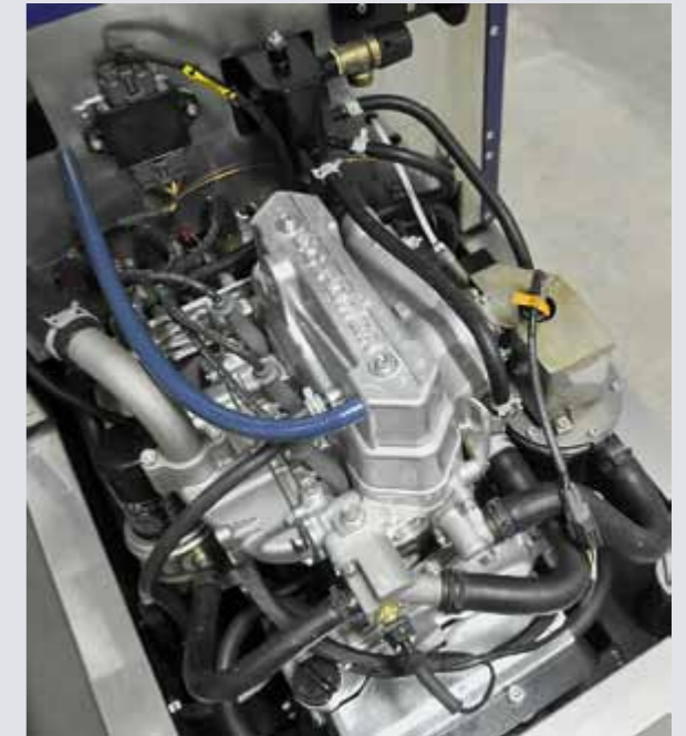
Für EC Power exklusiv auf lange Wartungsintervalle modifizierter Gasmotor des XRGI 9
